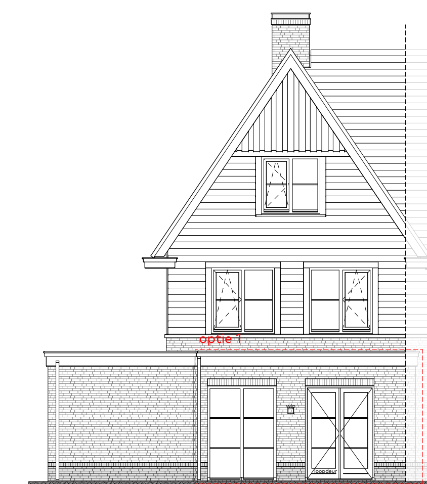
achtergevel schaal 1:100 voorbeeld gevel: bwnr 26 (type B2zp)
