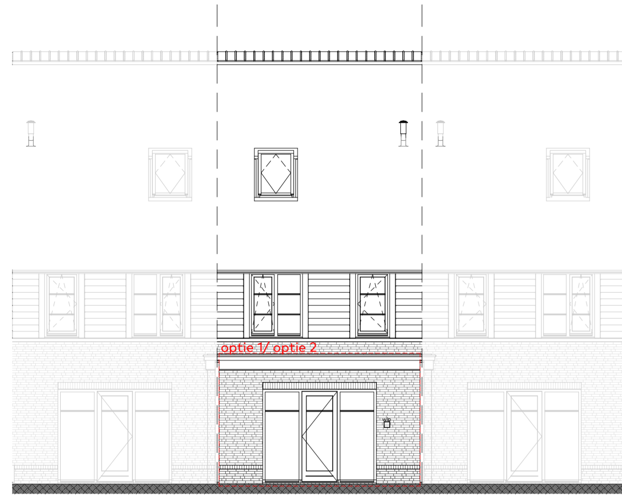
achtergevel schaal 1:100 voorbeeld gevel: bwnr 16 (type A2)
