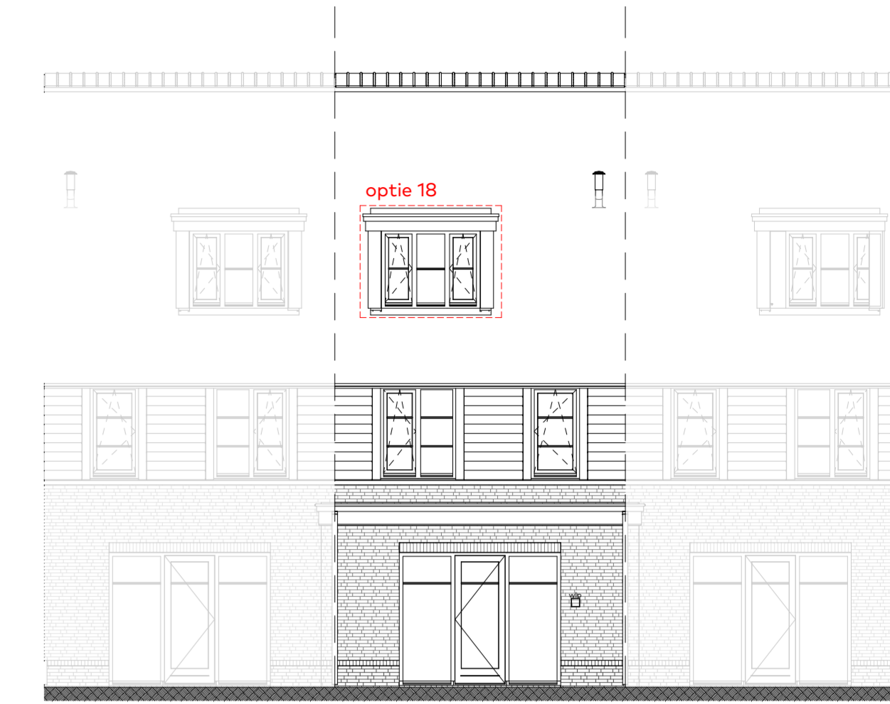
achtergevel schaal 1:100 voorbeeld gevel: bwnr 16 (type A2)
