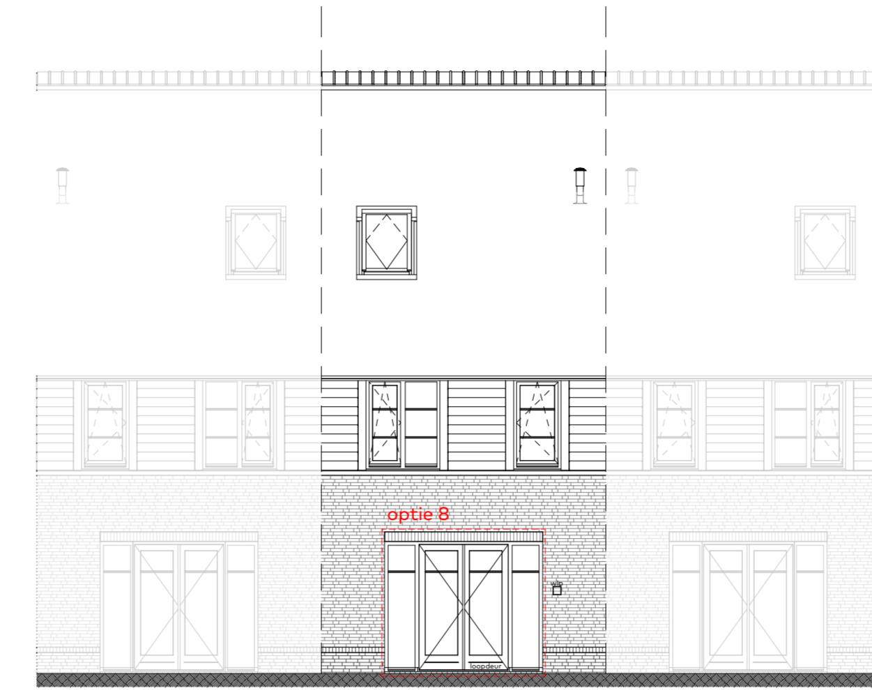
achtergevel schaal 1:100 voorbeeld gevel: bwnr 16 (type A2)
