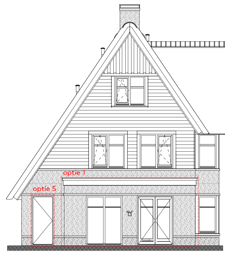
achtergevel schaal 1:100 voorbeeld gevel: bwnr 19 (type C2) optiemogelijkheden: optie 1: uitbouw 1,2m optie 5: deur berging (achtergevel)
